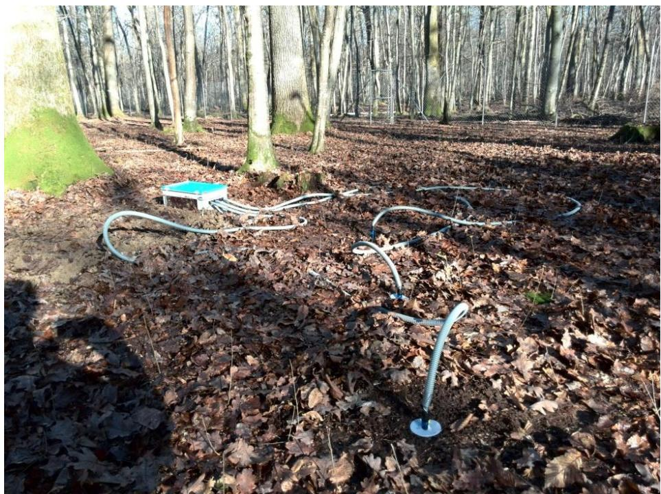
Slika 3.7.2. Set tlačnih lizimetara na plohi 110 Jastrebarski lugovi
