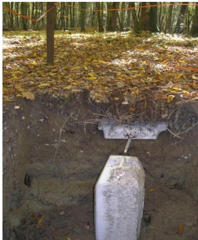
Slika 3.7.1. Gravitacijski lizimetar na plohi 110 Jastrebarski lugovi
