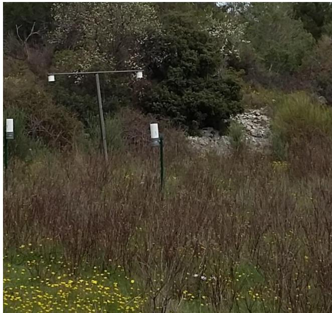
Slika 3.12.1. Pasivno mjerjenje ozona na plohi Vransko jezero
