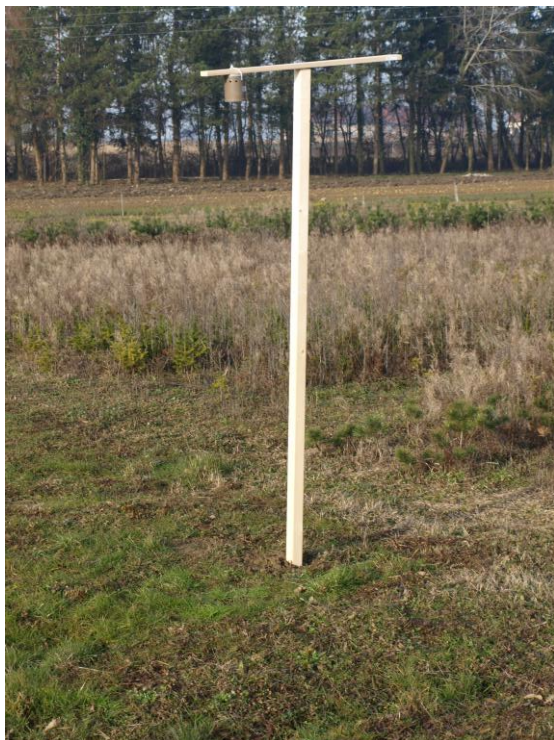
Slika 1 Oprema za pasivno mjerenje količine ozona
