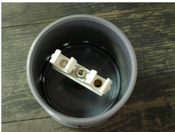
Slika 2 Unutrašnjost pasivnog mjerača ozona
