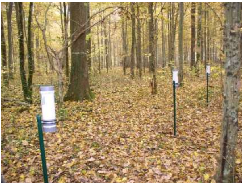
3.5.1. Postavljeni kišomjeri na plohi 109, Vrbanja
