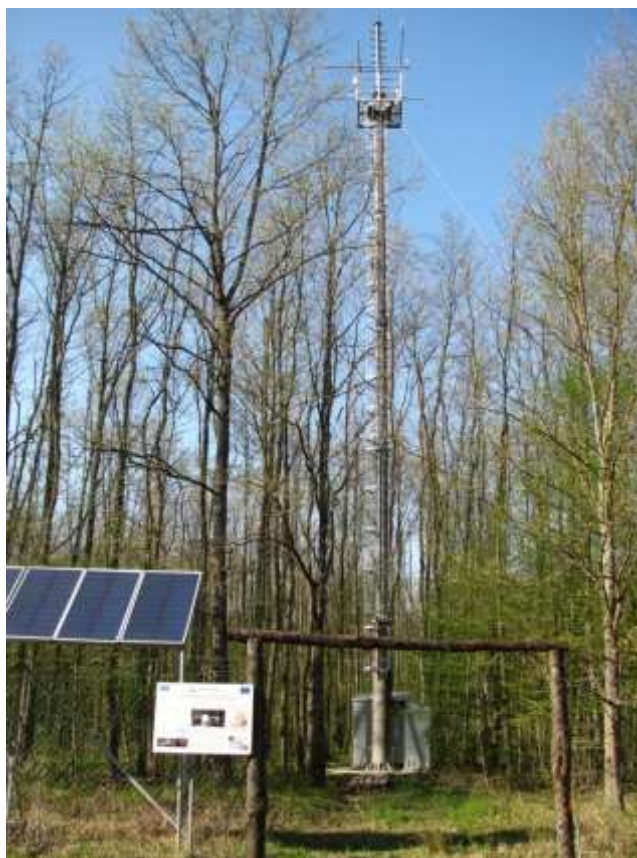
Slika 3.8.1. Stanica za intenzivno praćenje tokova CO 2 između šume i atmosfere u odsjeku 37a, g.j. „Jastrebarski lugovi“ s meteorološkom stanicom.
