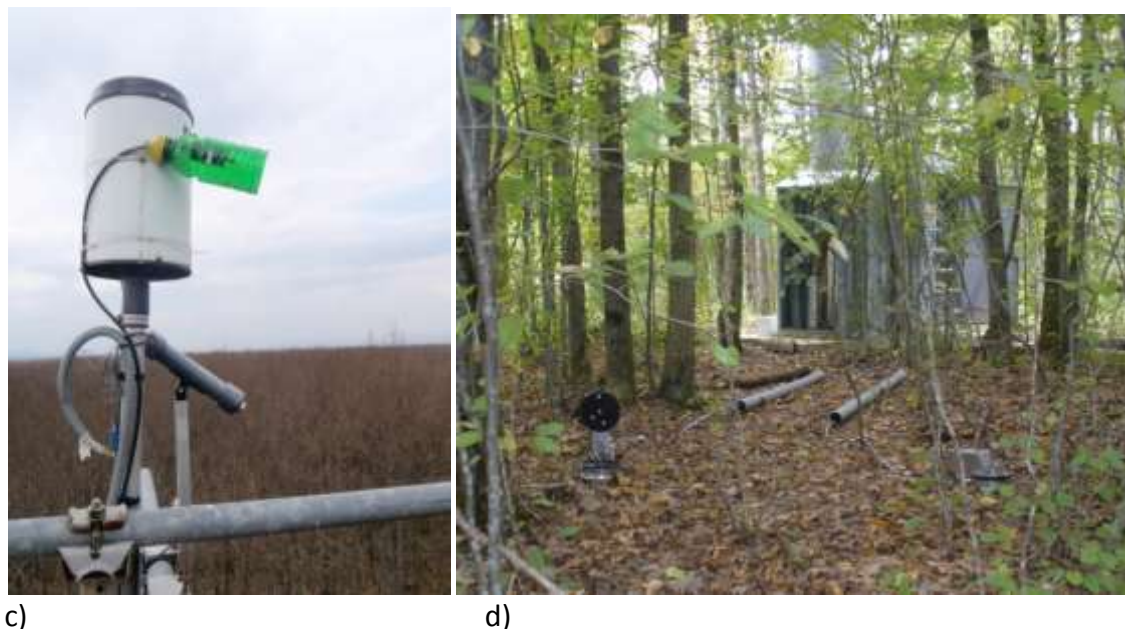
Slika 3.8.2a-d. Meteorološki instrumenti (u zagradi su oznake varijabli prema ICP protokolu kojima se mjeri: a) brzina i smjer vjetra (WS, WD), koncentracija CO 2 i vodene pare u zraku; b) temperatura i vlaga zraka (AT, RH), ukupno dolazno zračenje (SR), gustoća protoka dolaznog i reflektiranog fotosintetskog zračenja, neto zračenje; c) ukupne oborine (PR), temperatura lišća; d) temperatura tla termometrima na tri dubine (ST), udio vlage u tlu (WC), protok topline u tlu, i respiracija tla posebno konstruiranim sustavom s komorama.
