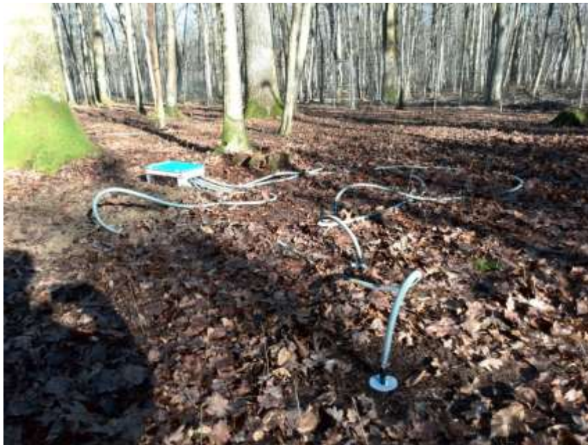
Slika 3.7.1. Set tlačnih lizimetara na plohi 110 Jastrebarski lugovi
