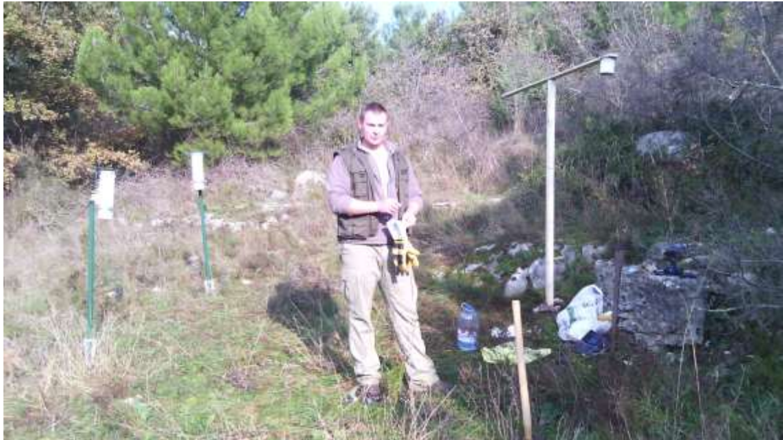
Slika 3.13.1. Oprema za pasivno mjerenje količine ozona – ploha 108 Poreč.
