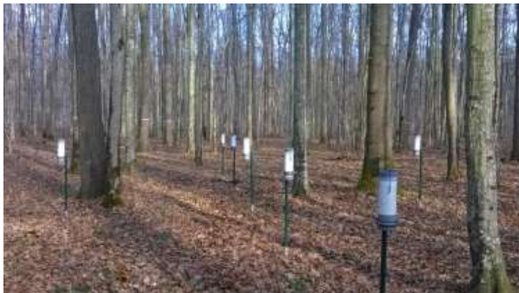
Slika 3.5.1. Kišomjeri na plohi Vrbanja (metoda prokaplivanja)
