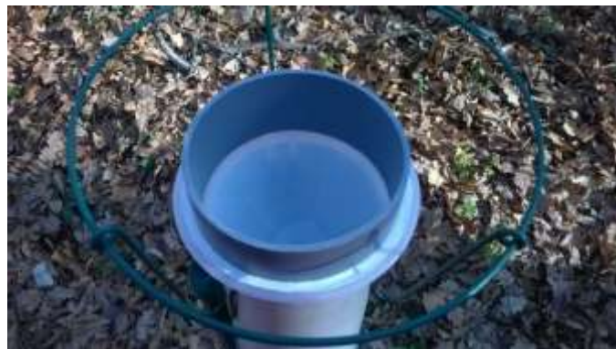
Slika 3.5.2. Prikaz kontrole kišomjera na plohi 109 (Vrbanja)
