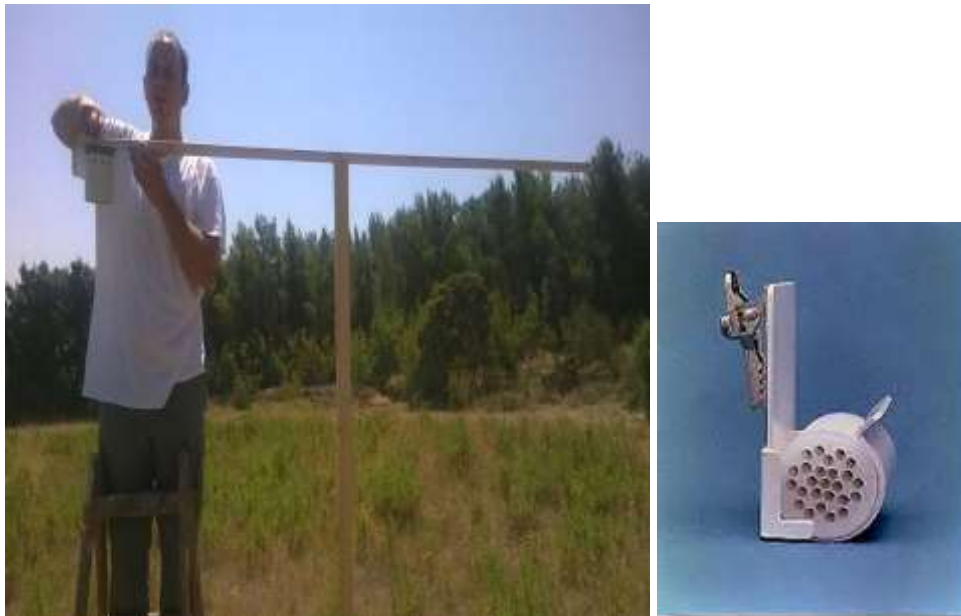
Slika 3.13.1. Postavljanje filtera za pasivno mjerenje ozona na plohi 105 (šumarija Biograd)
