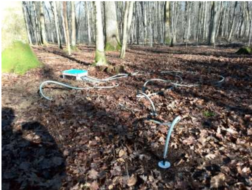
Slika 3.7.1. Set tlačnih lizimetara na plohi 110 Jastrebarski lugovi
