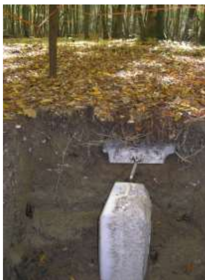
Slika 3.7.1. Gravitacijski lizimetar na plohi 110 Jastrebarski lugovi
