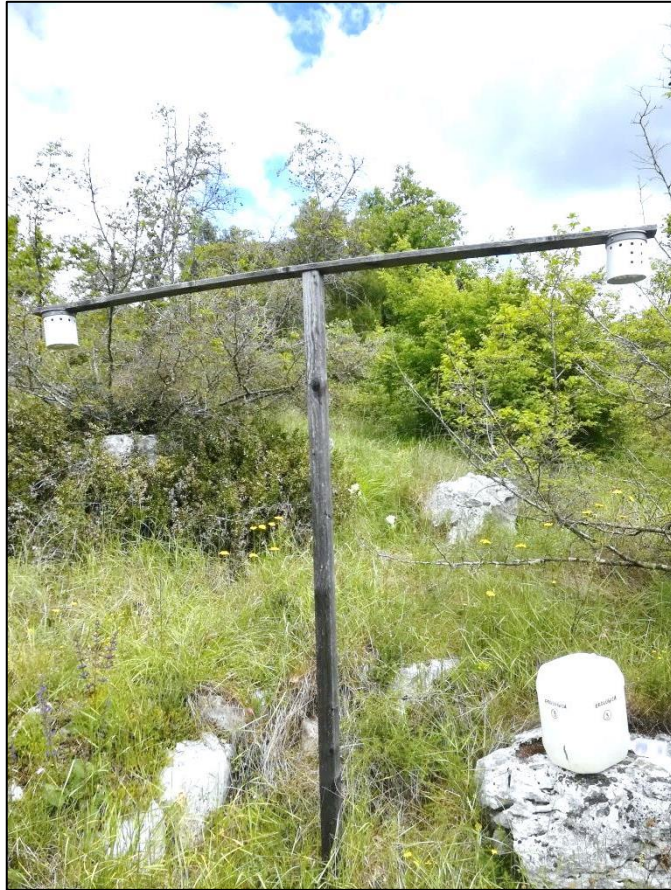
Slika 3.12.1. Pasivno mjerenje ozona na plohi Vransko jezero
