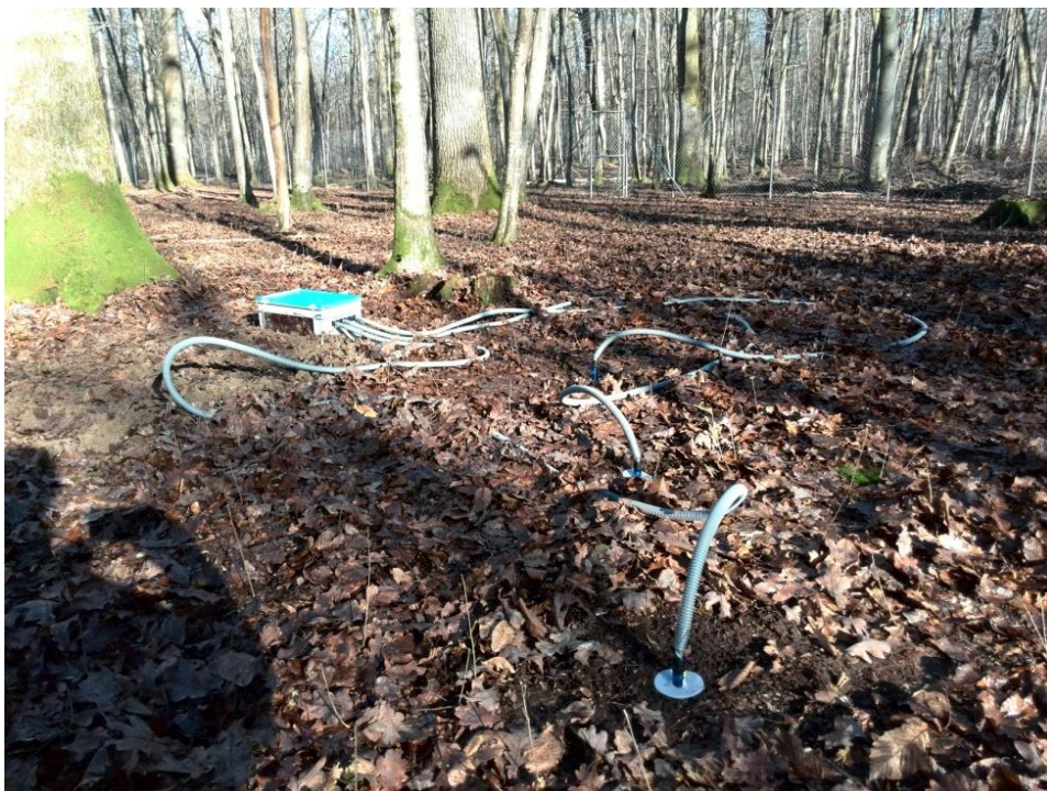
Slika 3.7.2. Set tlačnih lizimetara na plohi 110 Jastrebarski lugovi
