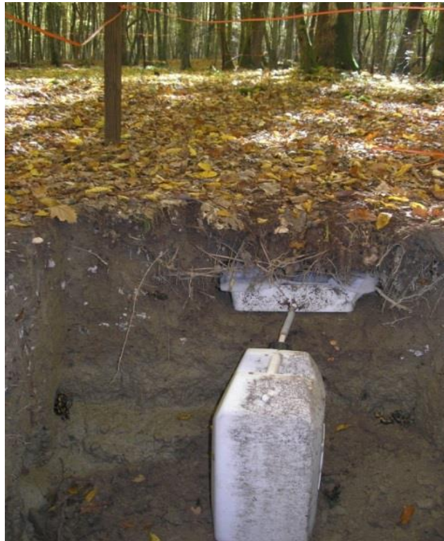
Slika 3.7.1. Gravitacijski lizimetar na plohi 110 Jastrebarski lugovi
