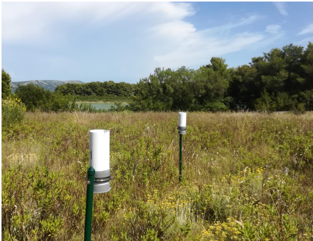
Slika 3.5.2. Kišomjeri na otvorenom (mokro taloženje, BOF) na plohi Vrana
