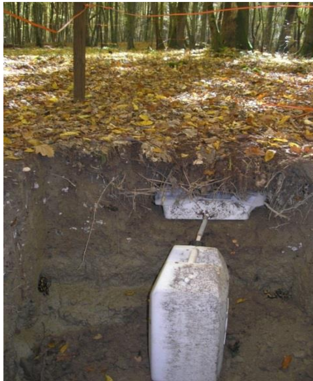
Slika 3.7.1. Gravitacijski lizimetar na plohi 110 Jastrebarski lugovi
