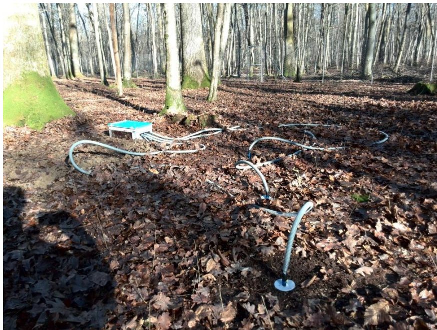
Slika 3.7.2. Set tlačnih lizimetara na plohi 110 Jastrebarski lugovi
