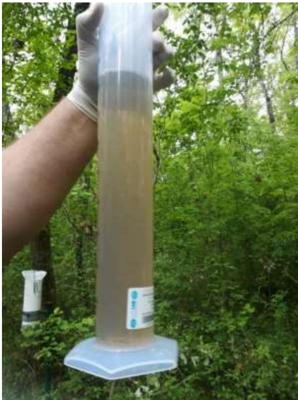
Slika 3.5.1. Određivanje volumena prikupljene kiše u šumi (prokapljivanje, THR) na plohi 108, Poreč
