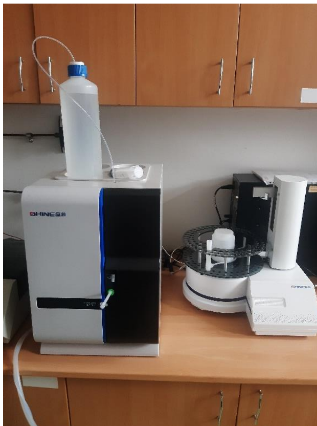
Slika 3.5.1. Ionski kromatograf za određivanje kationa u Laboratoriju HŠI u uzorcima dobivnim prokapljivanje i mokrim taloženjem
