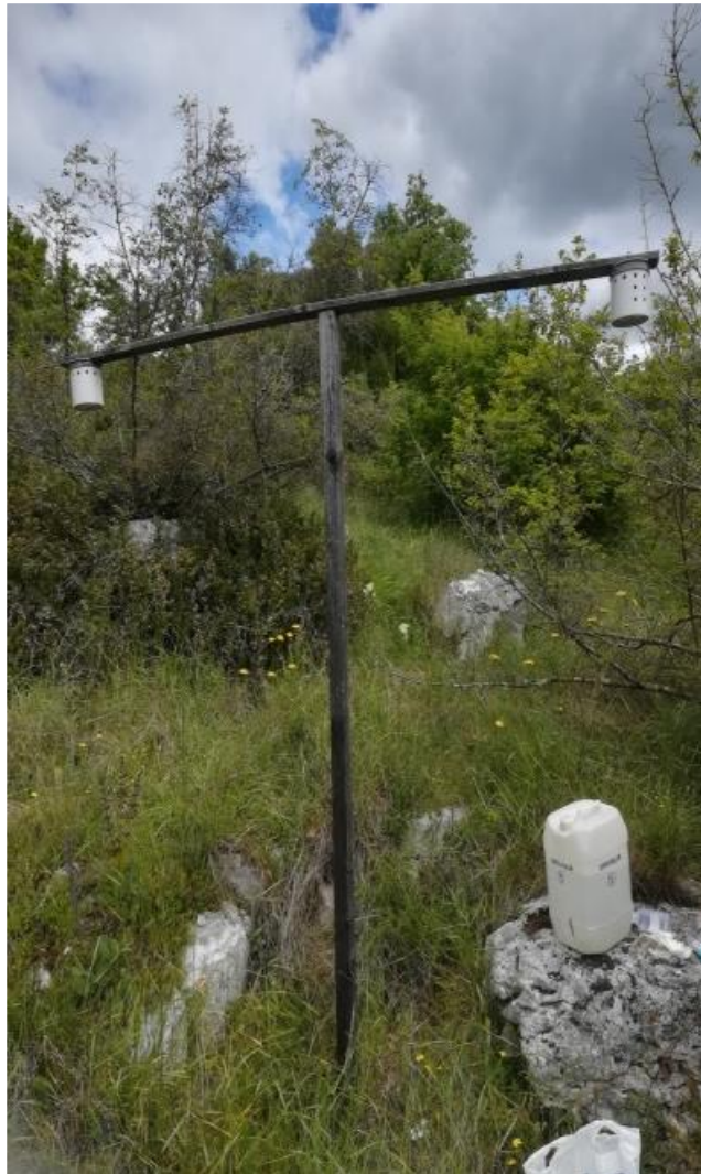
Slika 3.12.1. Pasivno mjerenje ozona na plohi Poreč (108)
