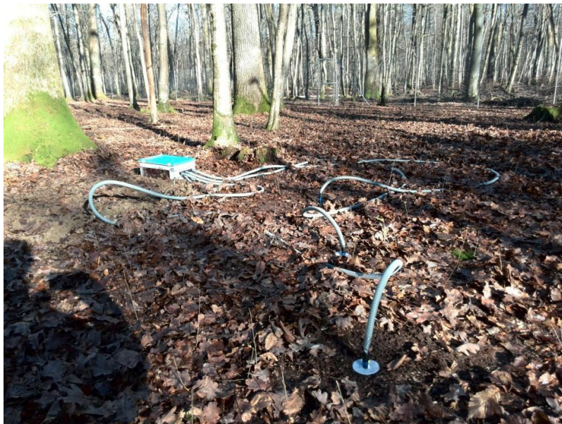
Slika 3.7.2. Set tlačnih lizimetara na plohi 110 Jastrebarski lugovi
